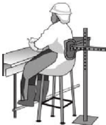
تصویر ( ۵ ) تغییرات اجزاء مختلف صندلی برای کارهای ایستاده نشسته
