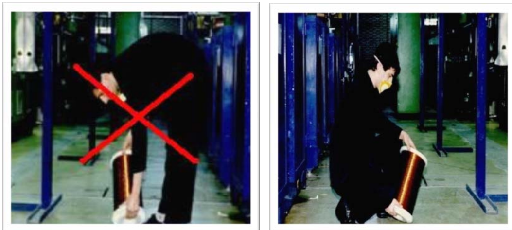
تصویر (۹۷) نحوه صحیح برداشتن و حمل بار قرقره های فلزی
