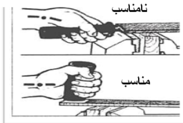
تصویر (۱۱۶) دسته ابزار با طراحی ارگونومیک از ایجاد وضعیت نامناسب جلوگیری می کند
