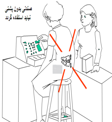
تصویر(۹) استفاده از صندلی بدون پشتی مسبب فشار بر روی ستون فقرات و آسیب در ناحیه کمر می شود
