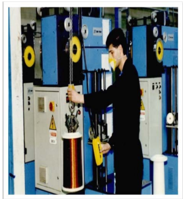
تصویر (۹۶) جرثقیل های سقفی برای حمل بی خطر و آسان بارهای سنگین در فواصل کوتاه و حداقل بالا بردن مناسب است.
