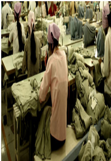
تصویر(۹) استفاده از صندلی بدون پشتی مسبب فشار بر روی ستون فقرات و آسیب در ناحیه کمر می شود
