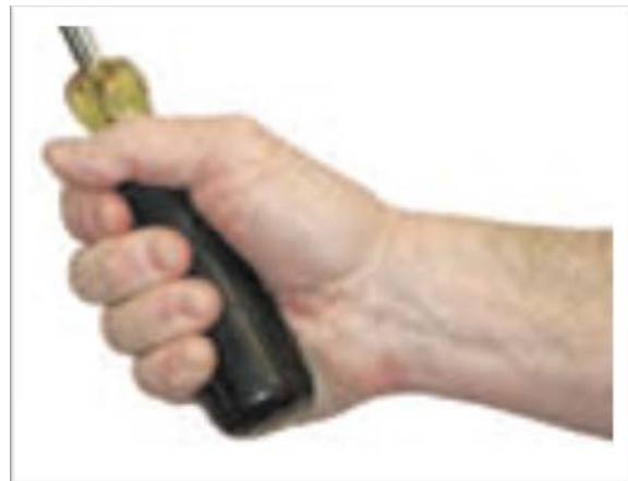
تصویر (۱۲۱) سطح دسته ابزار را با مواد دارای هدایت گرمایی پایین پوشاند
